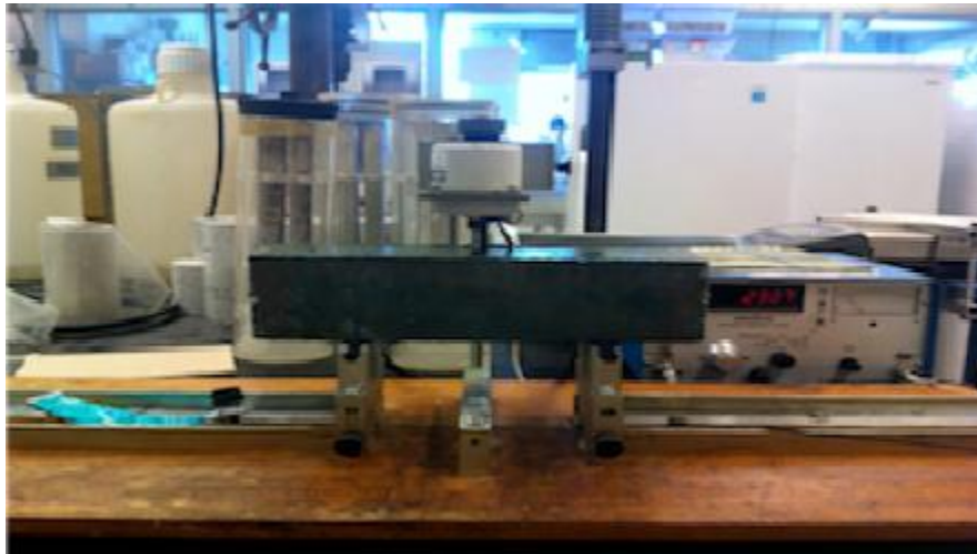
Prøvestykket fryses/tines i en beholder med rent vann. 1- 3mm klaring mellom prøvestykke og beholder.
