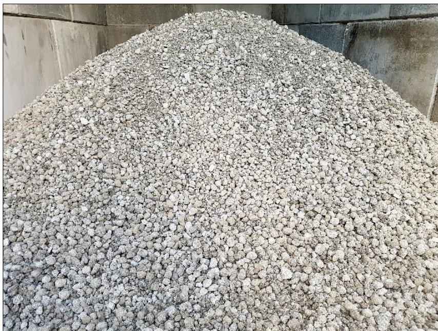
Figur 14: Returbetong som er kjemisk behandlet og tromlet til runde kuler/partikler som kan gjenbrukes som tilslag. Foto: Mapei
