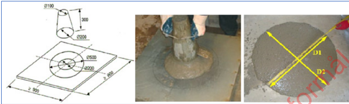
Figur 2 Test av slumpbredelse, gitt i NS-EN 12350-10.
