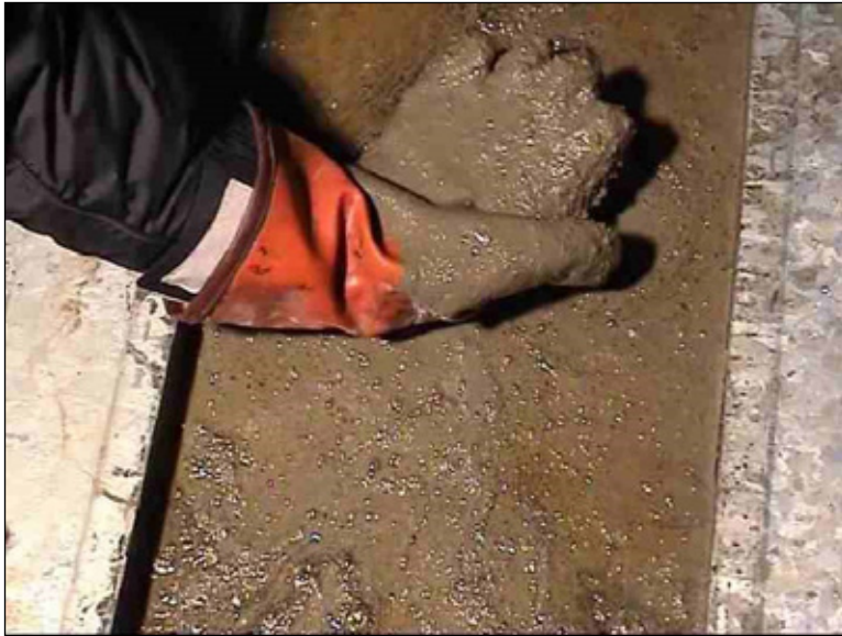
Figur 3.7. SKB med stor steinseparasjon
