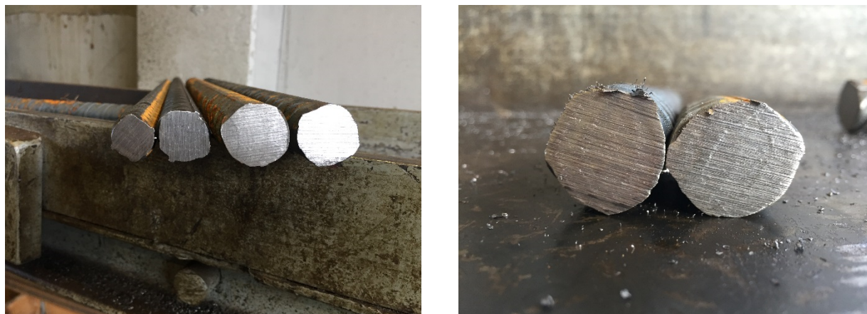
Figur 16 Eksempel på kamstål B500NC med ikke perfekt sirkulært tverrsnitt
