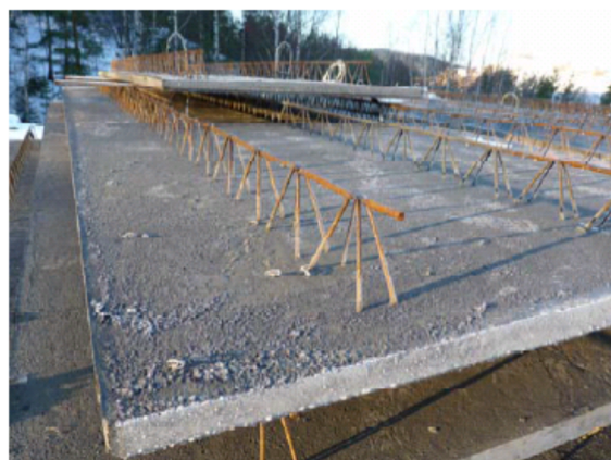
Figur 30 Ferdig prefabrikkert dekkeelement med gitterdrager
