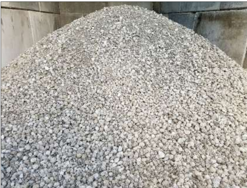
Figur 14: Returbetong som er kjemisk behandlet og tromlet til runde kuler/partikler som kan gjenbrukes som tilslag. Foto: Mapei
