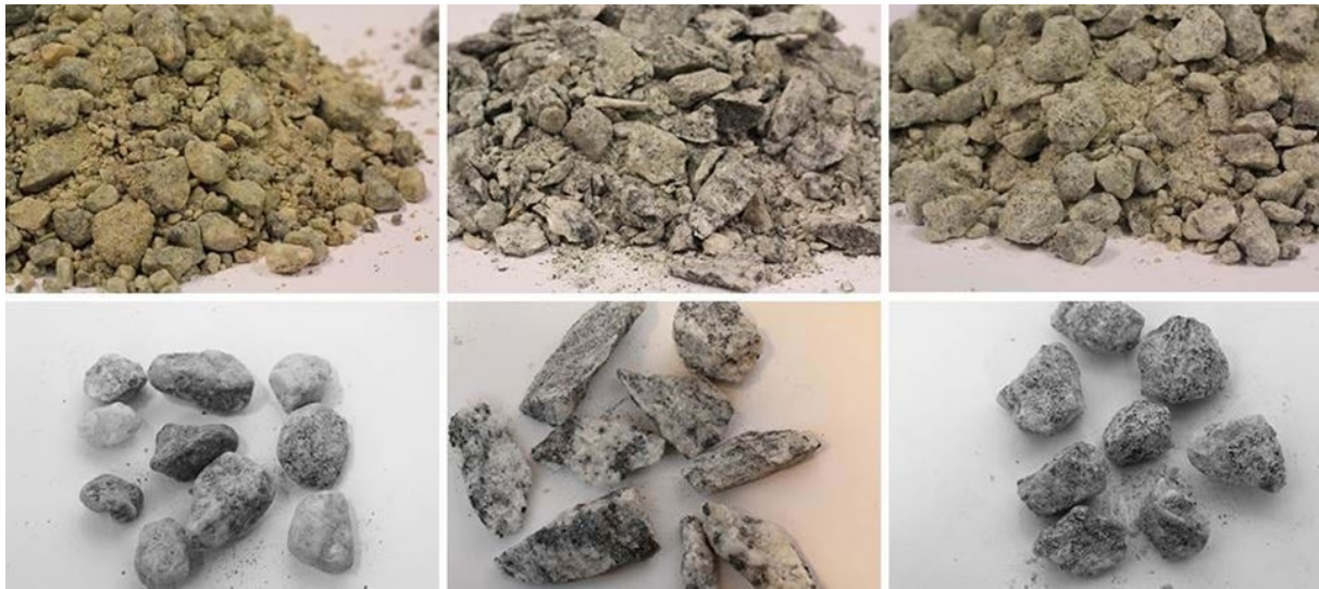
Figur 5-8: Illustrasjon av maskinsand. Bilder t.v.: høykvalitets, kubisk naturlig glasifluvial sand. Bilder i midten: lavkvalitet flisig subbus. Bilder t.h.: høykvalitets maskinsand produsert via en optimal knuseprosess, inklusiv VSI-knusing.
