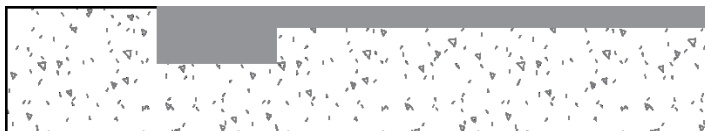
Figur 6-6 Kantavslutning mot eksisterende gulv
