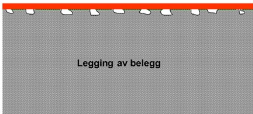
Figur 9-8 påføring av belegg på underlag med porer
