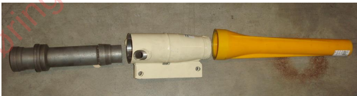
Figur 4-6: Eksempel på munnstykke med innerrør, blandekammer og sprøytespiss
