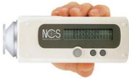
Bilde 7: Eksempel på elektronisk fargemåler (Håndholdt, batteridrevet NCS Fargemåler)
