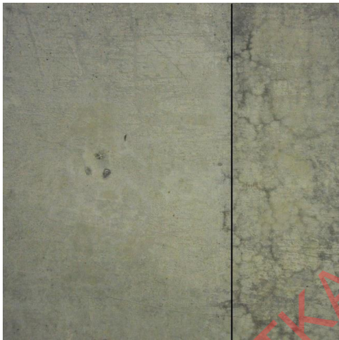
Bilde 40 Venstre felt er påført klar lasur tilsatt 10 % hvitt, høyre felt er ubehandlet.
