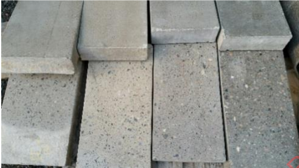
Bilde 5 Eksempel på prøvestøp for å finne ønsket farge
