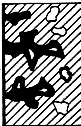
Fig. 4.3 Prinsipp for poreblokkerende impregnering
