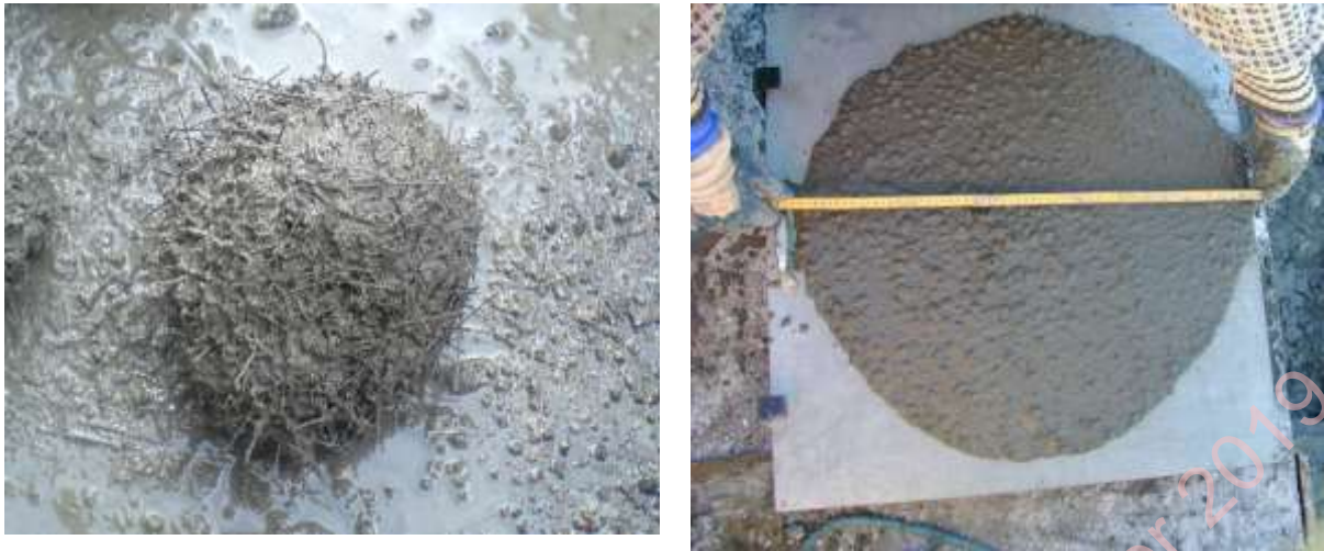
Figur 5.10: Eksempel på inhomogen betong med fiberballing til venstre. En homogen SKB med stålfiber er vist til høyre.
