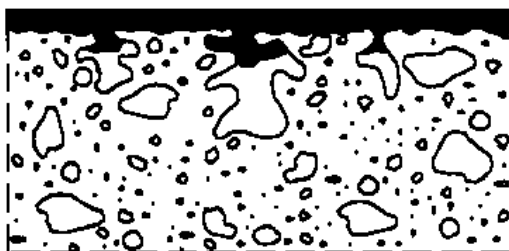
Figur 7.3 Skjematisk skisse av filmdannende belegg /7.1/
