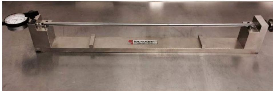
Figur A-1: Lengdemålingsrigg med 500 mm referansestav
